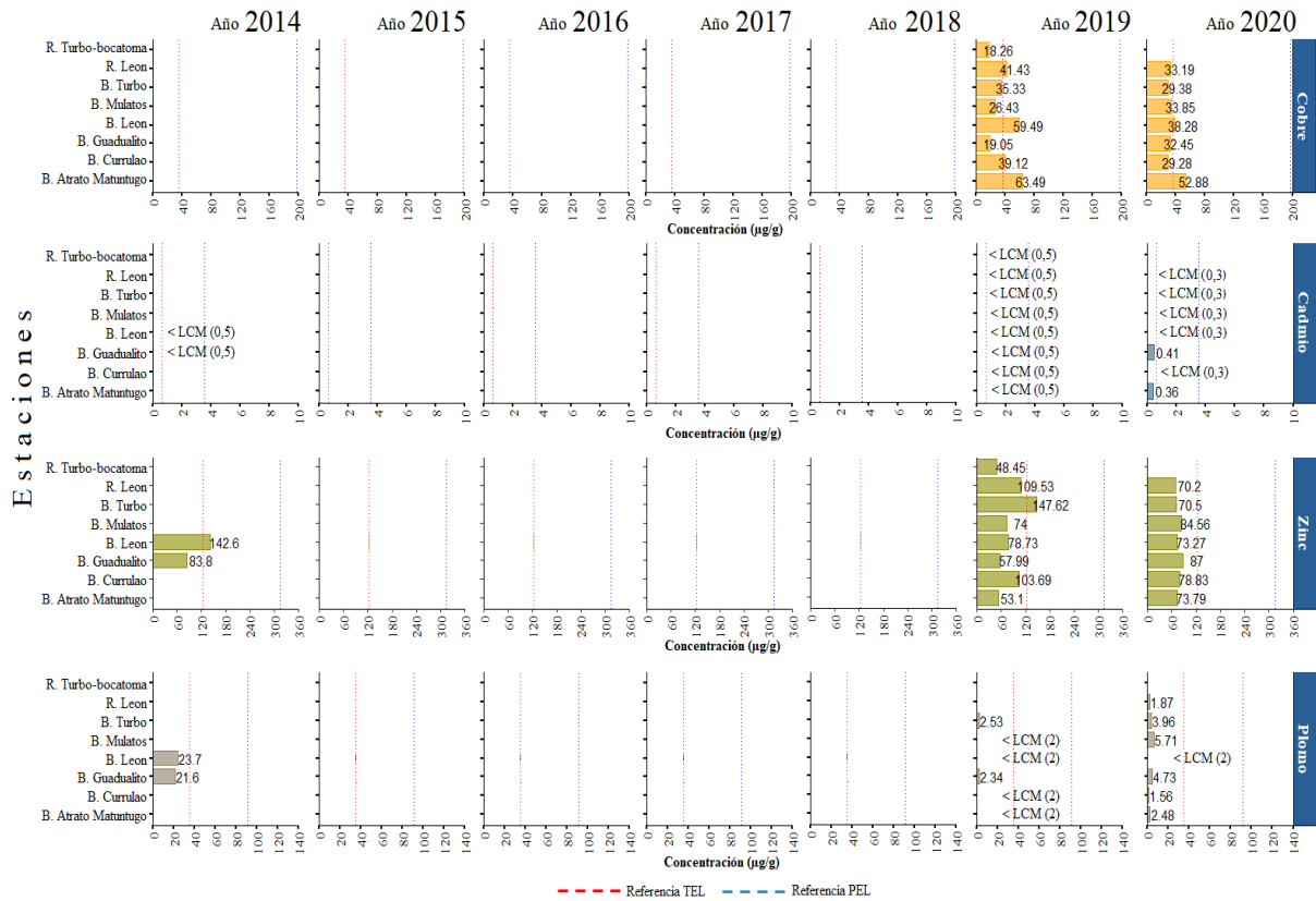
Figura 11-8. Concentración de metales totales en sedimentos de agua dulce recopilados entre 2014, 2019 y 2020 en el departamento de Antioquia. Los valores de referencia para efectos umbral (TEL) y efectos probables (PEL) se tomaron del Screening Quick Reference Tables (Buchman, 2008) para sedimentos de agua dulce. Las líneas verticales rojas representan los valores de referencia TEL y las de color azul los PEL. Las siglas (LCM) corresponden al límite de cuantificación del método utilizado en el LABCAM
