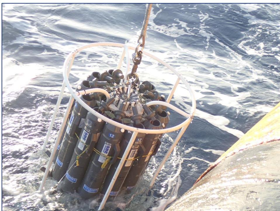
Muestreo de aguas, fitoplancton y clorofilas, en esta imagen, lanzamiento de roseta con botellas Niskin y CTD incorporadas. Foto: Henry Fabián Bustos.
