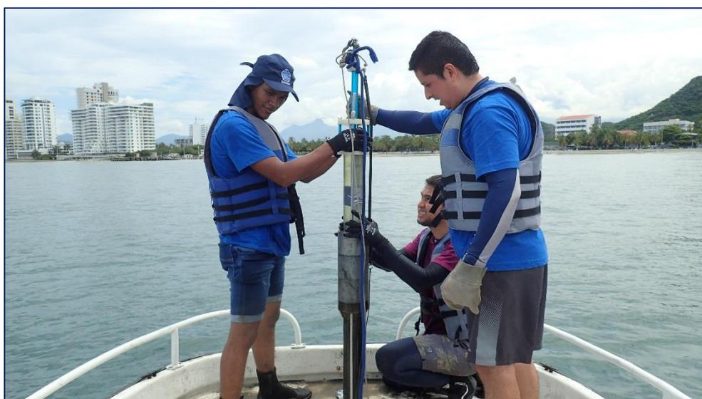
Muestreo de un testigo de sedimentos frente a la desembocadura del río Manzanares.
