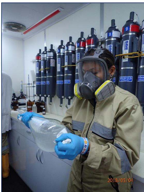
**Procesamiento de muestras de agua, en esta imagen, extracción de hidrocarburos en aguas. Foto: Ariadna Cárdenas.**
