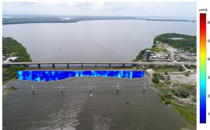
Figura 15. Sección transversal de la velocidad del agua ( $\text{cm s}^{-1}$ ) en la boca de La Barra para el 17 de diciembre de 2019 (INVEMAR, 2020a).
