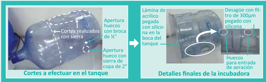
Figura 37. Elaboración de incubadoras de 12L para levante de crías de H. reidi .
