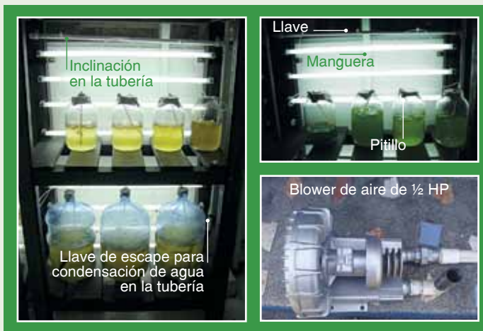
Figura 19. Montaje del sistema de aeración en el área de cultivo masivo.
