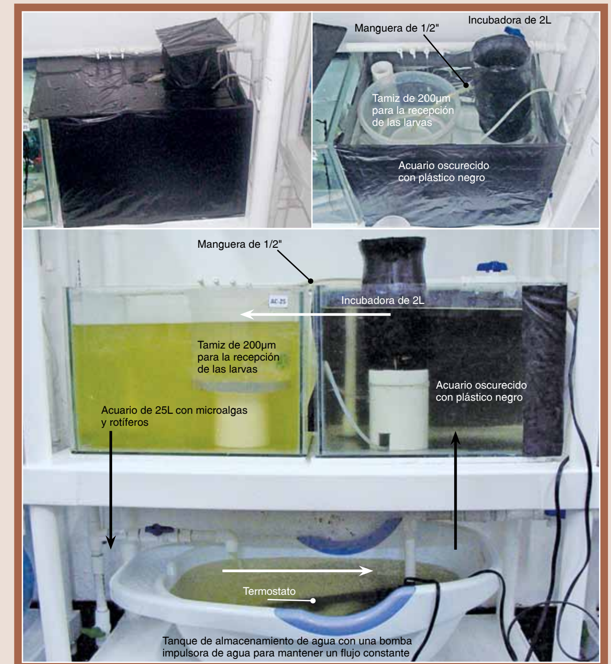
Figura 83. Incubadora de botella invertida (tipo Woynarovich) totalmente forrada utilizada para el montaje de las incubadoras. Sistema abierto (A) y sistema cerrado (B). Las flechas indican el recorrido del agua.
