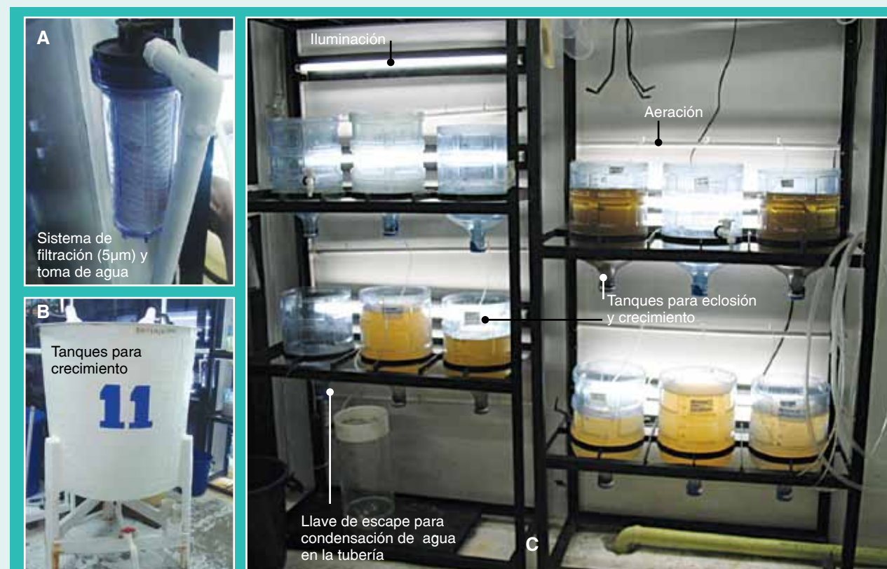
Figura 37. Cultivo de Artemia. Filtración (A), tanque para engorde (B) y sistema para eclosión y levante (C) (Ospina-Salazar et al. , 2011).
