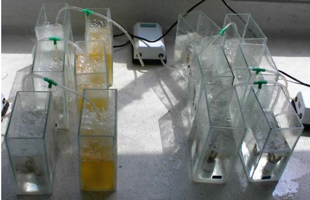
Figura 15. Montaje del bioensayo de toxicidad sobre corales
