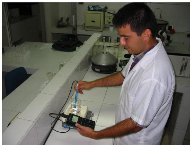
Equipo pHmetro WTW. Utilizado para medir el pH en laboratorio y en campo
