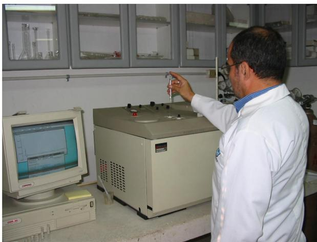
Cromatógrafo de gases Perkin – Elmer Auto System con detector ECD, utilizado para la identificación y cuantificación de compuestos organoclorados
