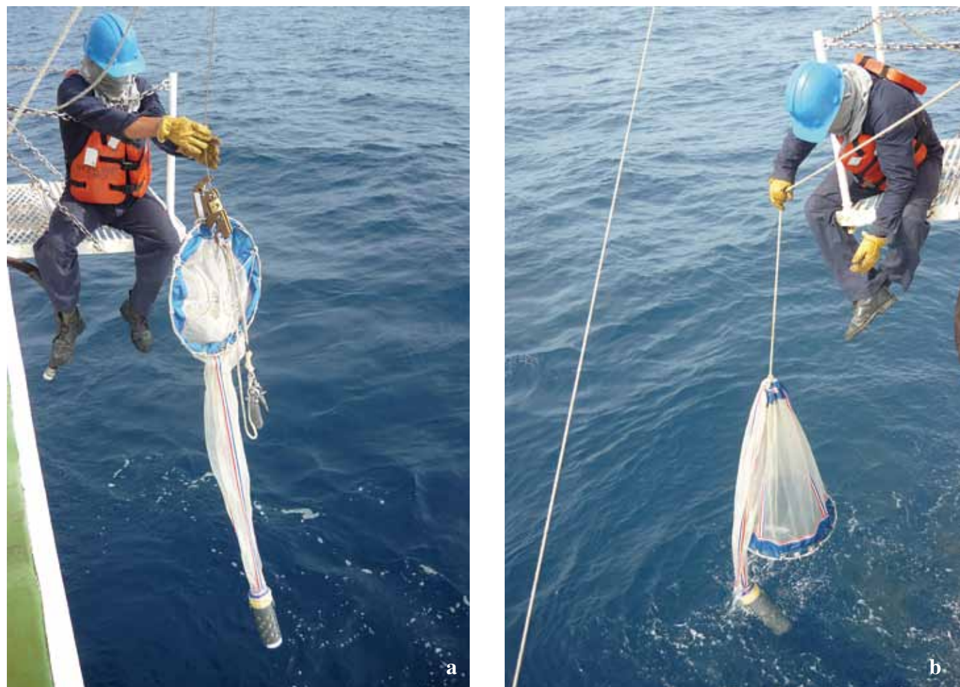
Figura 2. Muestreo con red de zooplancton. a. red con el sistema de apertura-cierre y b. red estrangulada.
