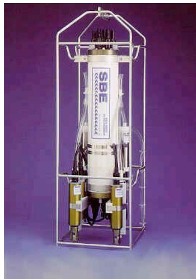
Figura 5-2 Instrumentos tipo CTD. Izquierda: instrumento para mediciones en aguas profundas. Derecha: versión más ligera, para usarse en embarcaciones pequeñas, en estuarios y aguas costeras (tomado de *Seabird Electronics* © 2000).
