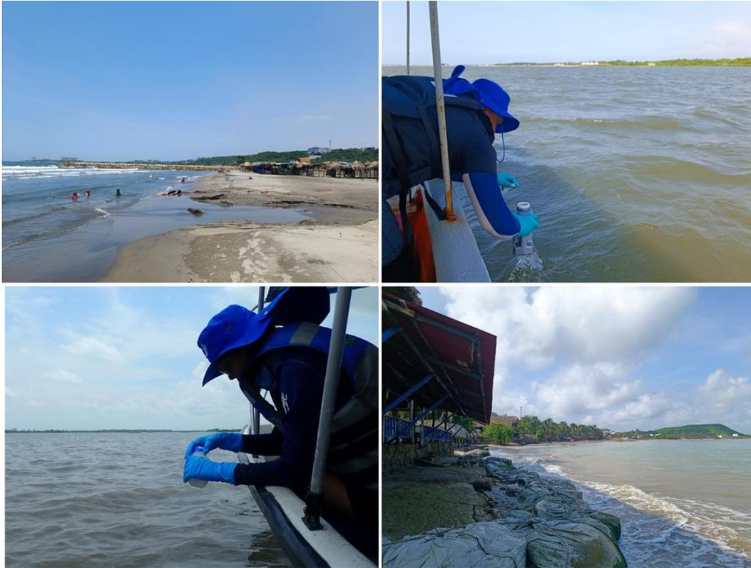
Figura 9-3. Toma de datos *in situ* y colecta de muestras de agua en las estaciones REDCAM Atlántico.
