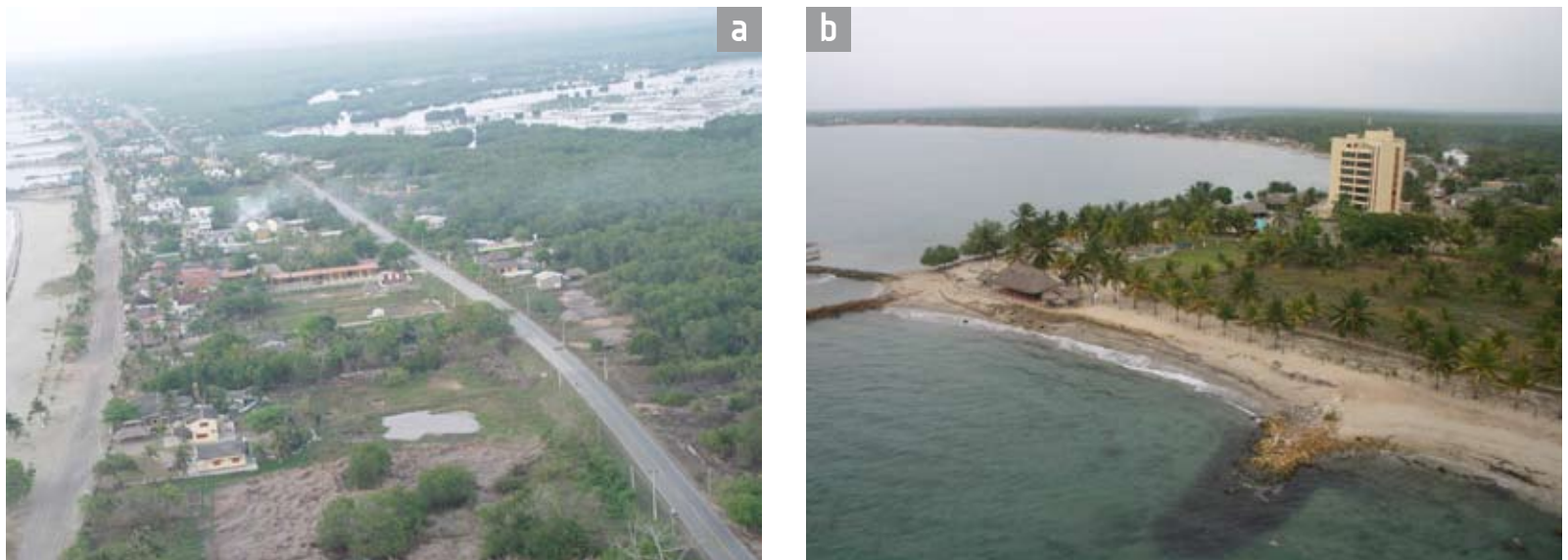
Figura 6.32. Playas protegidas por espolones y tajamares que sin embargo muestran poca recuperación. a) En la boca de la ciénaga La Caimanera; b) En punta Piedra (fotos CARSUCRE).
