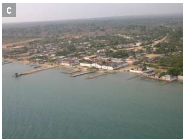
Figura 6.31. a) Playa de Guacamayas con escarpe de erosión moderado y pendiente de playa alto; b) Acumulación de materiales a manera de espolón que contribuyen al deterioro de la playa en puerto Berrugas (fotos Programa GEO-INVEMAR); c) Puerto Berrugas protegido por múltiples espolones para defenderlo de la erosión de las playas sin efecto positivo aparente (foto CARSUCRE).
